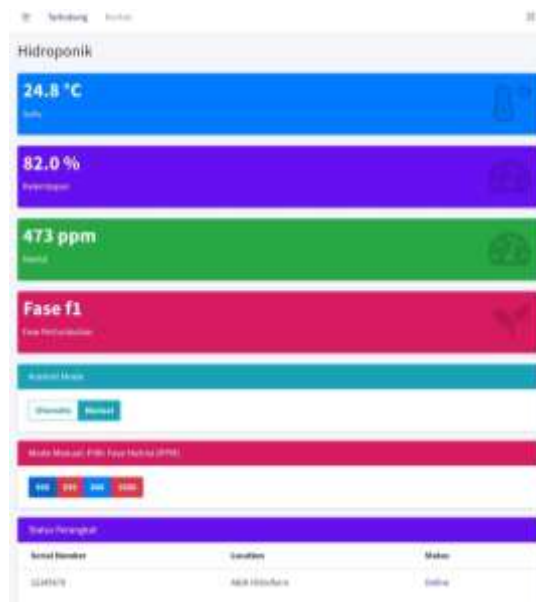
Gambar 8. Web monitoring dan kontrol hidroponik
